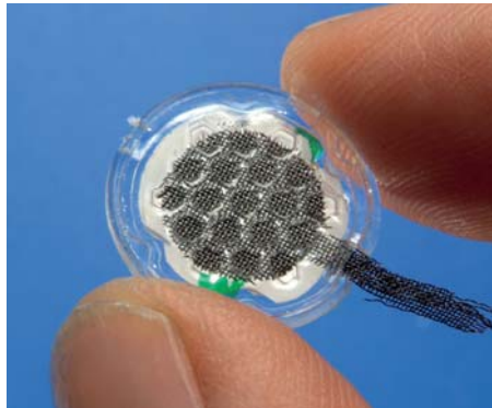
Fig. 5: Das Herzstück der Mikropumpe der zweiten Generation ist ein thermisch verschweisstes Sandwich aus verschiedenen Materialien.
