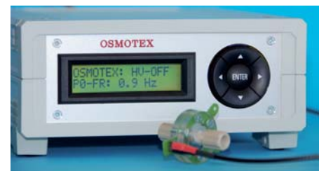
Fig. 8: Spannungsversorgung für die Mikropumpen der 2. Generation mit Mikropumpe im Vordergrund.
