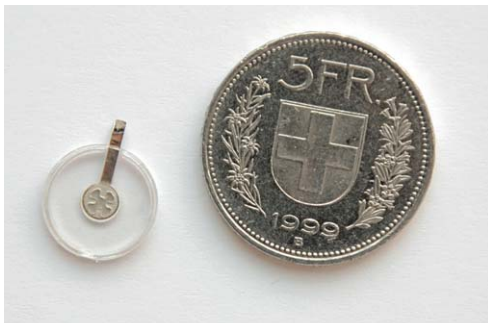
Bild 1: Herzstück der Mikropumpe ist ein kompaktes, thermisches verschweisstes Sandwich, das die Elektroden, Membranen und polarisierbaren Elemente zu einer pumpenden Einheit verbindet. (Bild Osmotex)
